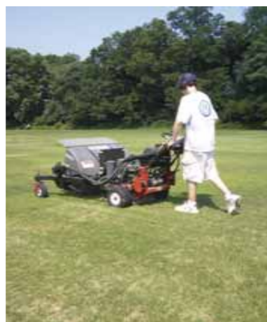
Test de résistance au piétinement.
